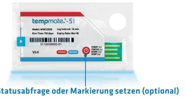
02 Einmal kurz Drücken um den aktuellen Status abzufragen, zweimal kurz drücken um eine Markierung zu setzen. (Auflistung der Funktionen siehe Tabelle unten)
