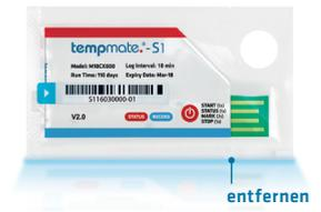
04 Nach dem Stopp der Aufzeichnung die Plastikhülle aufreißen und den Logger an einem USB Anschluss am PC anschließen. Der PDF & CSV Bericht wird automatisch erstellt und ist im „tempmate“ Verzeichnis am PC zu finden.
